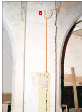
Beispiel: Aufzeichnung der Verformung an der Basis der Spitzbögen eines 7,20m breiten Gewölbes. Kirche Saint Saturnin de la Forêt Sainte Croix (91). Architekt für denkmalgeschützte Gebäude – Louis PRIEUR
