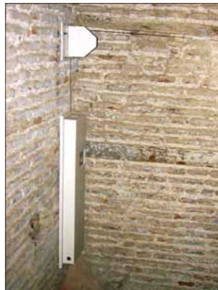
Beispiel: Aufzeichnung der Verformung von tragenden Mauern eines Kreuzgratgewölbes mitten im Bogen. Medina in Fès - Médersa Attarine aus dem 14. Jahrhundert
